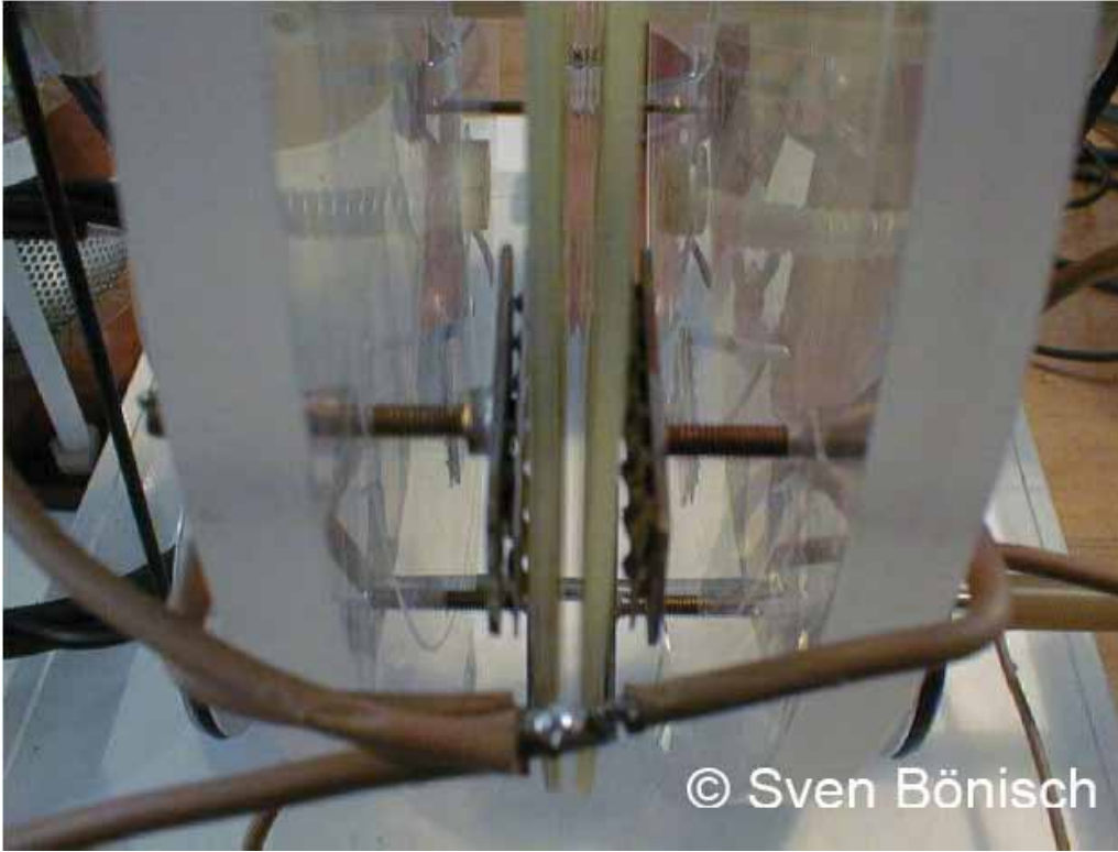
الشكل ٥: تموضع الأقطاب عند النهايات HV1 و HV2
