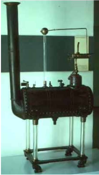
آلة "أرمسترونغ" الهيدروكهربائية والتي استخدمت البخار كحامل شحنات
