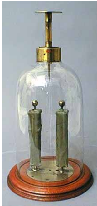
عبارة عن كومتين جافتين وبينهما بندول مربوط بسلك معدني ويتأرجح إلى الأبد
