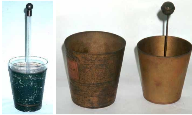
مرطبانات ليدن مؤلفة من أكواب معدنية متداخلة قابلة للفك والتركيب، عبارة عن كوبين معدنيين يتخللهما كوب عازل
