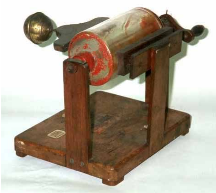
آلة كهروستاتية بسيطة تعمل على الاحتكاك
