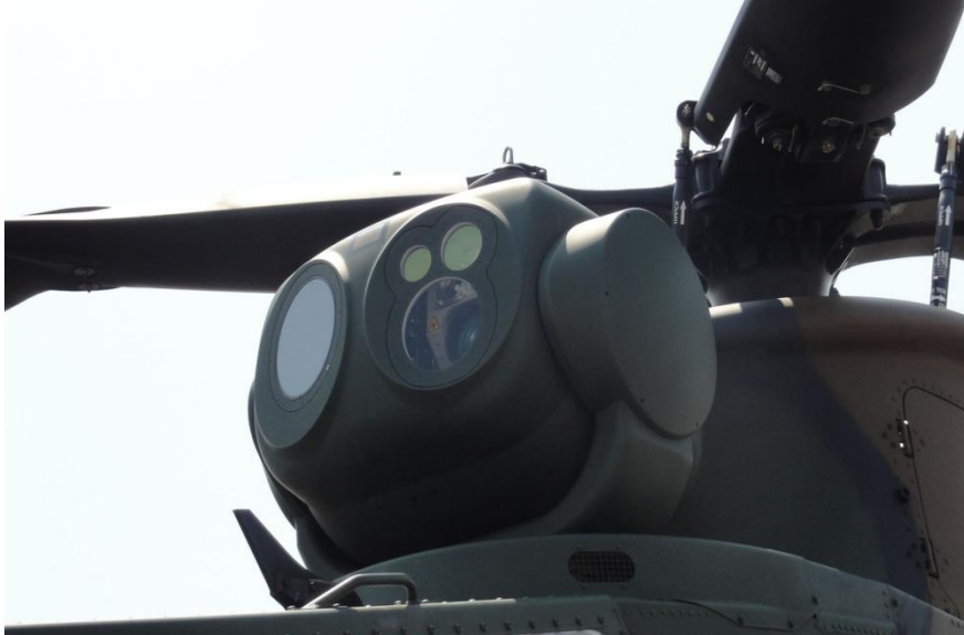
المستشعر الكهرو بصري الموجود على الجزء العلوي من جسم الطائرة OH-1 - 1
